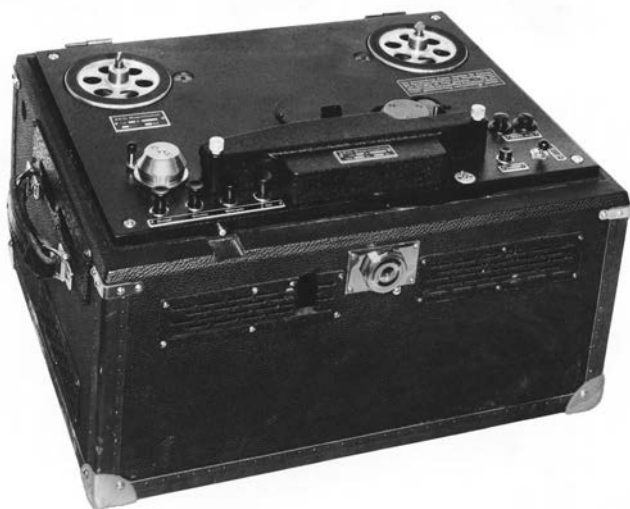
Äußerlich fast baugleich mit dem verbreiteten Magnetophon K4 ist das Laufwerk des – laut Archiv-Unterlagen – ersten HF-Magnetophons. Es dürfte der Ausführung gleichen, mit der am 10. Juni 1941 das neue Aufzeichnungsverfahren öffentlich vorgestellt wurde. © Archiv GFGF
